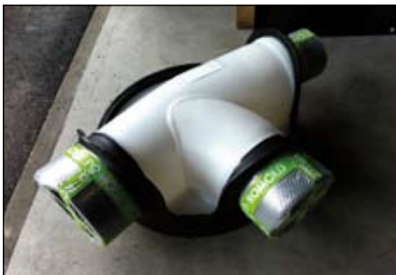
3.) Vorgefertigtes Gerinne mit PE-Stützen
